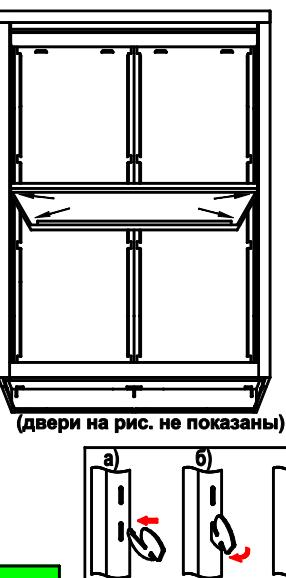
Регулировку уровня производить с подкладывания пластин (входит в комплект поставки).
